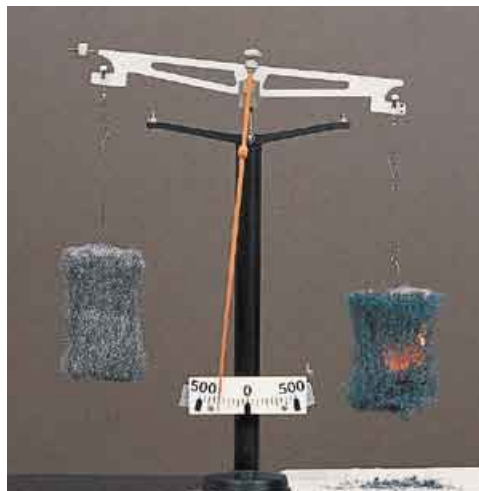
3 Eisenwolle wird an einer Balkenwaage erhitzt.
